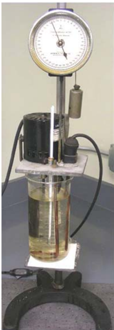
FIG. 1 Shrinkage Meter Apparatus (“Shrinkometer”)
